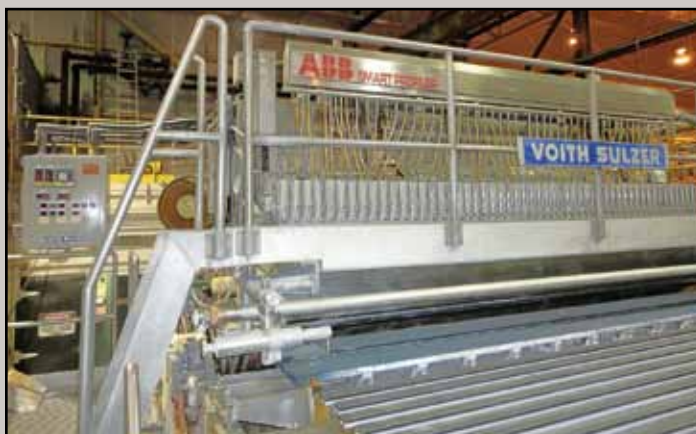
VOITH SULZER 316L AIR-PAD RECTIFIER HEAD BOX AND ABB SMART PROFILER (PM4)
